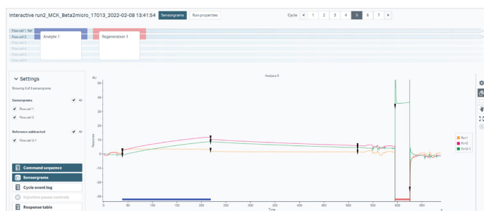
図 13. Interactive run の例。各サイクルにはアナライトのインジェクション (複数の濃度) と再生ステップが含まれます。その後、Biacore™ Insight Evaluation Software において、全データセット (7 サイクル) を 1:1 のモデルにフィッティングしました (data not shown)。(アナライト: β2 ミクログロブリン。リガンド: Sensor Chip CM5 にアミンカプリング法で固定化した抗 β2 ミクログロブリン)
