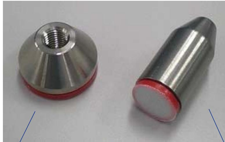
フィルター外径は15 mmです。外径1/8インチまたは3/16インチチュービングを直接挿入し、ねじ込んで固定します。
