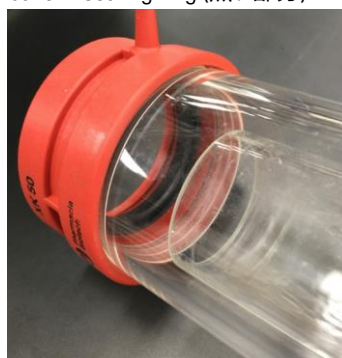
↑ガラス管が内側へスライドして built-in sealing ring から外れてしまっている様子
