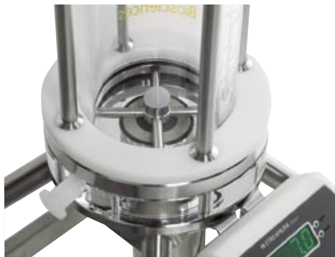
STREAMLINE Direct カラムには「拡張吸着流動床 (EBA)」の簡便性と生産性を高めるデザイン改良が施されています。例えば、カラム下部のネットをなくし、下側に注入口のある振動アームを備えた分散システムで原料を注入します。
