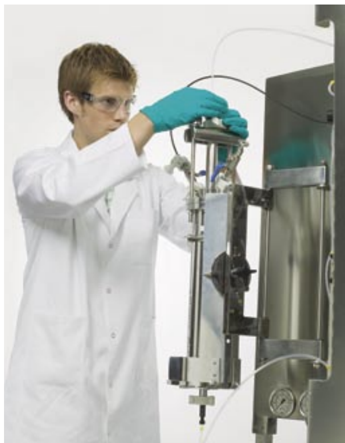
図 1. オリゴヌクレオチド合成のため OligoPilot 400 システムに FineLINE 70 カラムを接続。
