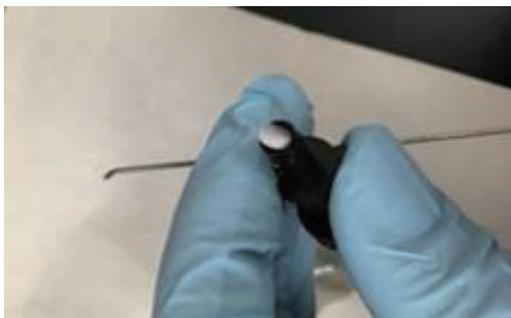
5) フィルターホルダー内部にはまっているフィルターを Tricorn Filter tool またはピンセットなどの道具で取り出し、新しいものと取り替える（取り替えるフィルターはあらかじめ超純水中で湿らせておいてください）
