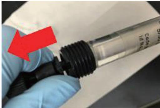
3) Finger tightコネクタを Filter holderにしっかり取り付け、Finger tightコネクタのいちばん太い部分を持ってゆっくり引き抜く（Finger tightコネクタは貫通型の構造のため、この操作中の空気の逃げ口となりカラム内は陰圧になりません）
