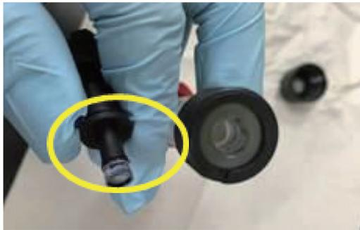
4) 外れたフィルターホルダーの側面には担体が付着しているので、超純水ですすぎ落とす（O-ring 周囲についた超純水はふき取らなくてよいです）
