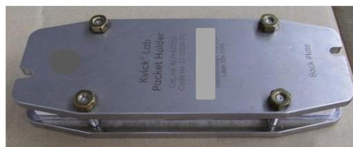
注意：Kvick Lab Packet Holder 付属のレンチを使用すると、トルク設定が出来ないため、ネジを破損する恐れがあります。
