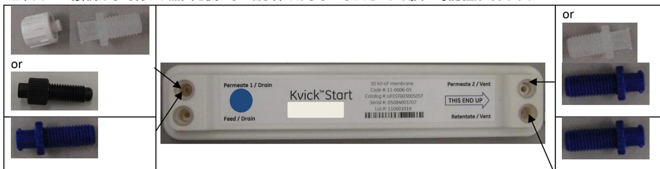
3) カートリッジのルアーロックと、チュービング先端のルアーロックコネクターを接続します。
