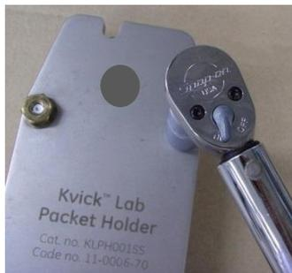
Back Plate にコネクタを取り付けます。コネクタとプレート間にガスケットを挟みます。下側の Permeate と記載されているポートのみストッププラグを使用します。
