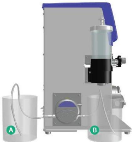
6) トランスファーポンプを低 RPM（たとえば 30 RPM）で稼働し、1 分あたりの流量を計測します。
