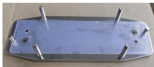
ガスケットの上にカセットを重ねます。Kvick Lab Packet で複数枚のカセットを使用する場合は、更にカセットを重ねます（カセット間にガスケットを挟む必要はありません）。
