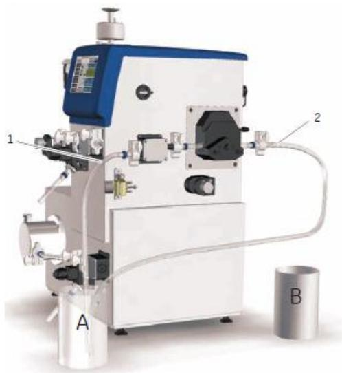
2) A のビーカーに超純水を入れ、パーミエイトポンプを適当な RPM（たとえば 50RPM）で稼働し、チュービング内のエアを除きます。この時、接続部から液漏れがないことを目視で確認します。
