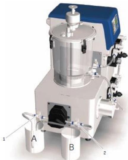
2) A のビーカーに超純水を入れ、トランスファーポンプを適当な RPM（たとえば 100RPM）稼働し、チュービング内のエアを除きます。この時、接続部から液漏れがないことを目視で確認します。
