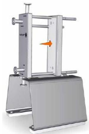
6) カートリッジを Kwick Lab Holder with stand に挟み込みます。カートリッジのシリコンコーティングされている側がフローディストリ
