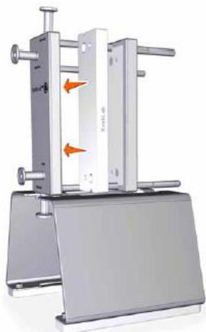
8) バックプレートをフローディストリビューションマニホールド側へ滑らせて、スペーサー、ワッシャー、ナットで固定します。ここでは手で操作するようにしてください。
