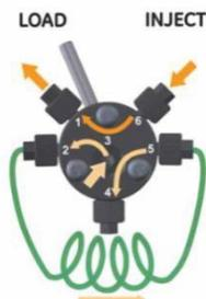
1. Injection valve のポジションが **LOAD** になっていることを確認します。（下図参照）
