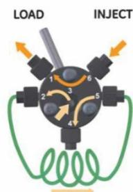
2. サンプルループの洗浄および液漏れの確認を行います。インジェクションバルブのポジション 3 に開始バッファーを満したシリンジを挿入します。
