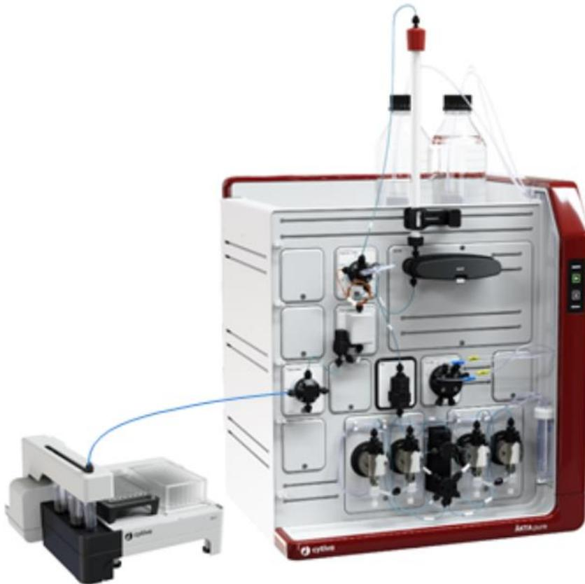
マイクロキットは、既存の ÄKTA™ pure 25 M の流路をマイクロスケール精製用に最適化するツールです。マイクロキットには、ÄKTA™ pure micro で使用されているものと同じコンポーネントとチュービングが含まれています。
