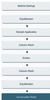
高塩濃度のバッファーを使用した場合、**Accumulator** をバッファーのまま放置するのではなく、精製水で自動洗浄することをメソッドに組み込むことができます。
