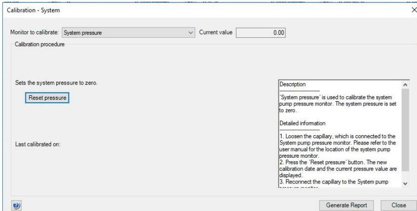
2、キャリブレーションが必要な圧力センサー部分のコネクターを外して開放します。
