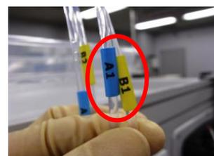
2、パージバルブにパージキットをしっかりと差し込み、パージバルブを反時計回りに約 3/4 回転して、シリンジのピストンをゆっくり引いて、エアが無くなるまで概ね 10~20 ml 分の超純水を引き入れます。
