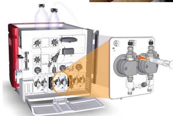
A2 および B2 のインレットについてパーズを行う場合は、以下 6～9 の手順で行います。A3～A7、B3～B7 にインレットを増設して使用する場合にも、インレットチュービングを超純水入りのボトルに接続し、インレット名を読み替えて、同様の手順で行います。
