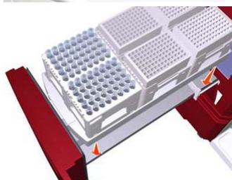
6、引き出しを閉めると、自動的にカセット場所の認識が開始します。図のように異なる種類のカセットを一度にセットすることも可能です。正しく認識されたかどうかは、以下の手順で確認します。
