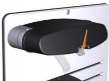
2. 検出器とフローセルをモニターから取り外します。強く引っ張りすぎて UV フローセルを破損しないように注意してください。
