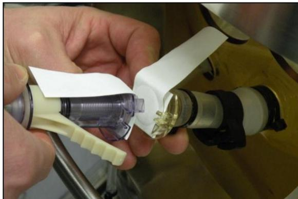
6) プローブ側をバッグ側のポートに合わせる。爪の位置を確認後、コネクタを装着する（奥まで挿入し、緩みが無いことを確認）。
