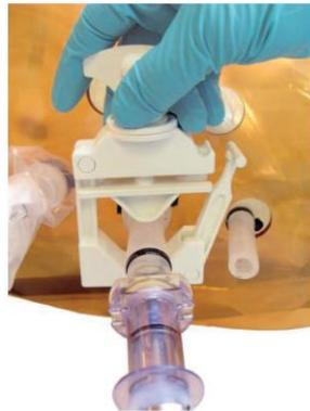
13) 使用しないプローブポートや、万一プローブ接続を失敗したポートがある場合、クランプで閉じます
