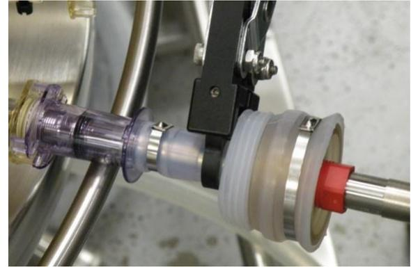
11) 蛇腹側のクランプを専用ツール（プライヤー、888-0341）で締め込む（コネクターの上からではなく、プローブの上の部分で締めます）。
