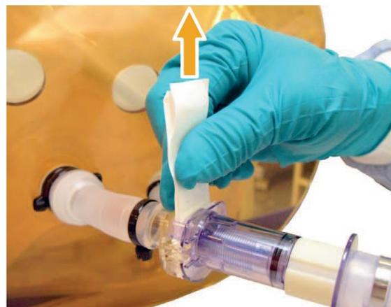
7) 白いmembrane stripを2枚同時に引き抜く。このタイミングでプローブ側とバッグ側が貫通します。
