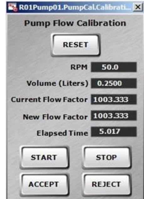
必要に応じ、キャリブレーション終了後にPIDフェイスプレートのLocalモードで送液し、トータライザーに表示される積算流量と回収される溶液量を比較します。
