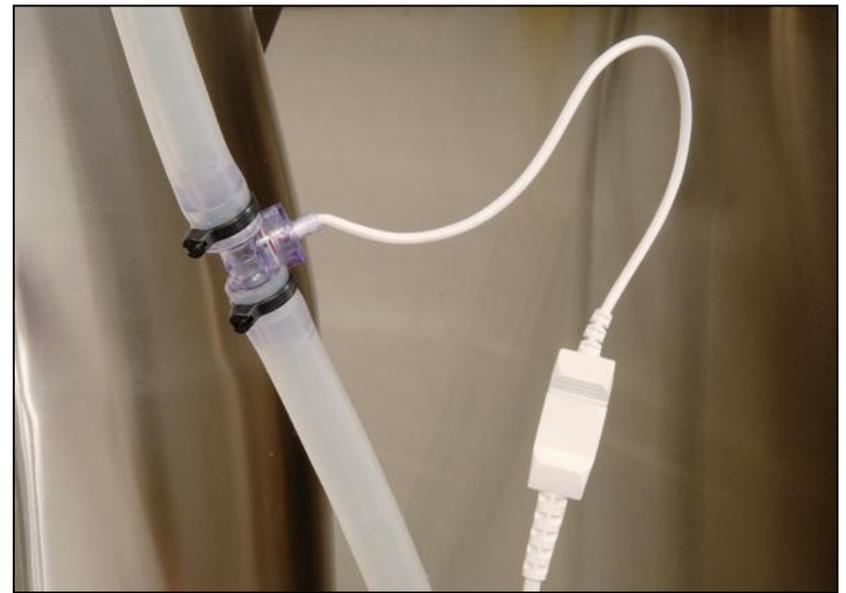
12. ガスチューブを、バッグのフィルターポートに取り付ける
