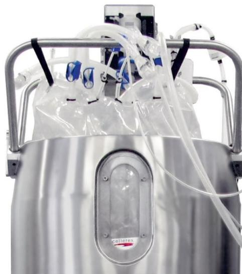
9. 200L以上のバッグの場合、バッグを膨張させる過程で上部4ヶ所をバンドで固定する。無理やり持ち上げると、ベッセルとバッグの間に隙間が発生しやすくなります。
