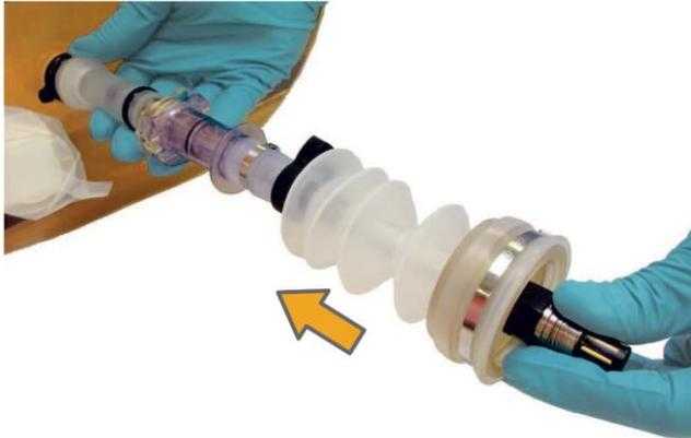
10) プローブを奥まで押し込む（プローブの先端が数mmバッグ内に突出します）。
