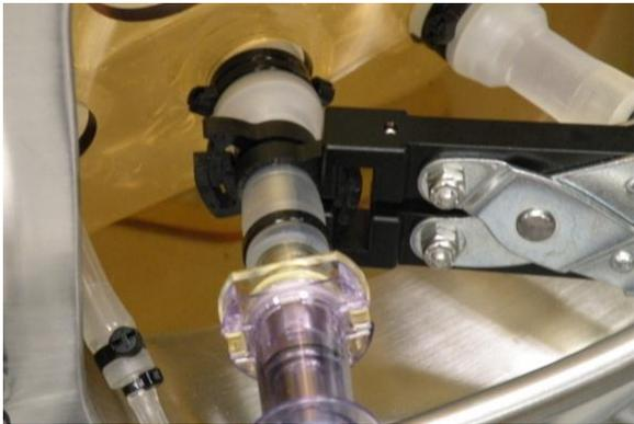
12) 最初にステップ2でセットしたクランプを専用ツール（プライヤー、888-0341）で締め込む（コネクターの上からではなく、プローブの上の部分で締めます）。この時、締め込む場所を90度以上ずらした方が作業しやすくなります
