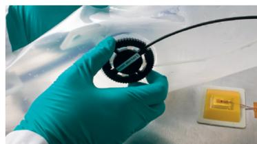
Xuri Cellbagアダプタ/光ファイバケーブルは、Xuri Cellbagバイオリアクター表面に埋め込まれたポートに取り付けられています。
